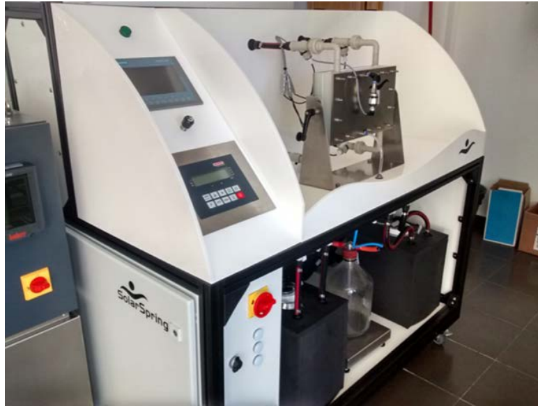
Figura 72. Banco de ensayos para evaluar la destilación por membranas con membranas planas.
