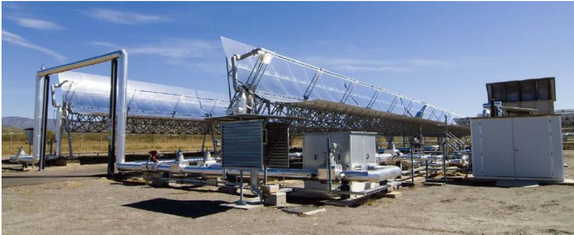
Figura 12. Vista de la instalación experimental IFL (con captadores cilindroparabólicos) utilizando gas comprimido como fluido de transferencia de calor.
