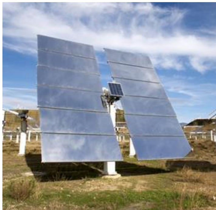
Figura 25. Un heliostato autónomo en el campo SSPS-CRS.
