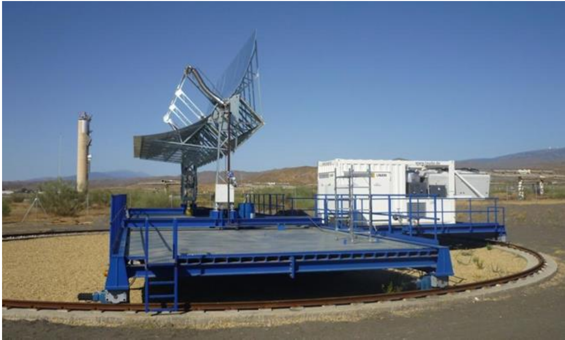
Figura 15. Vista lateral del banco de ensayos KONTAS y la unidad de calefacción/refrigeración (lado derecho).
