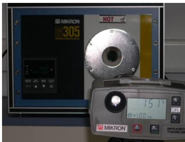
Figura 62. Sensor de calibración IR utilizando un cuerpo negro.
