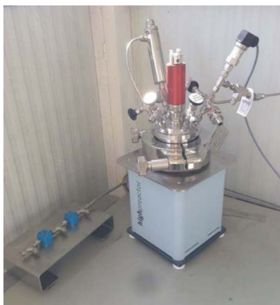
Figura 50. Planta piloto de oxidación por aire húmedo
