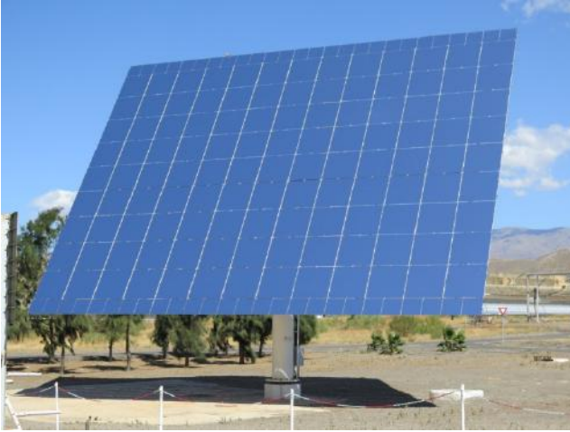
Figura 27. Heliostato HT120 en seguimiento.
