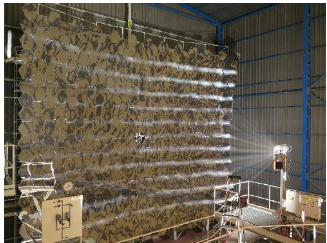
Figura 30. Vista interior del Horno Solar SF-60 de la PSA en funcionamiento.
