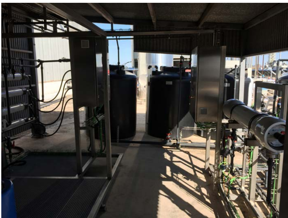
Figura 41. Banco de ensayos para la investigación combinada de FO-RO.
