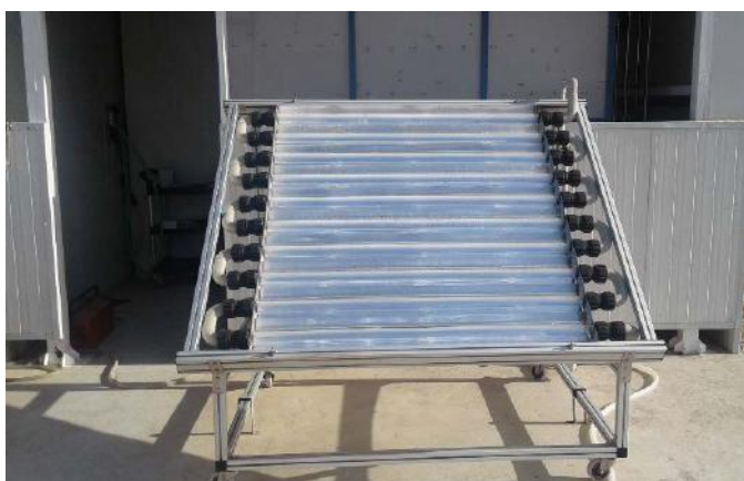
Figura 44. Vista de un CPC 2 m 2 (ELECTROX) acoplado a planta piloto Electro-Fenton.
