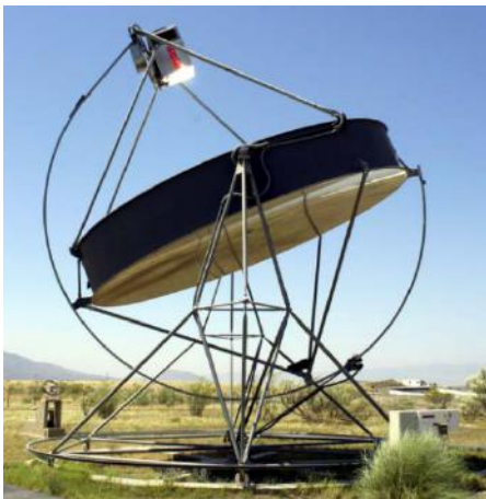
Figura 34. Vista del disco parabólico DISTAL-II con el motor original Stirling.
