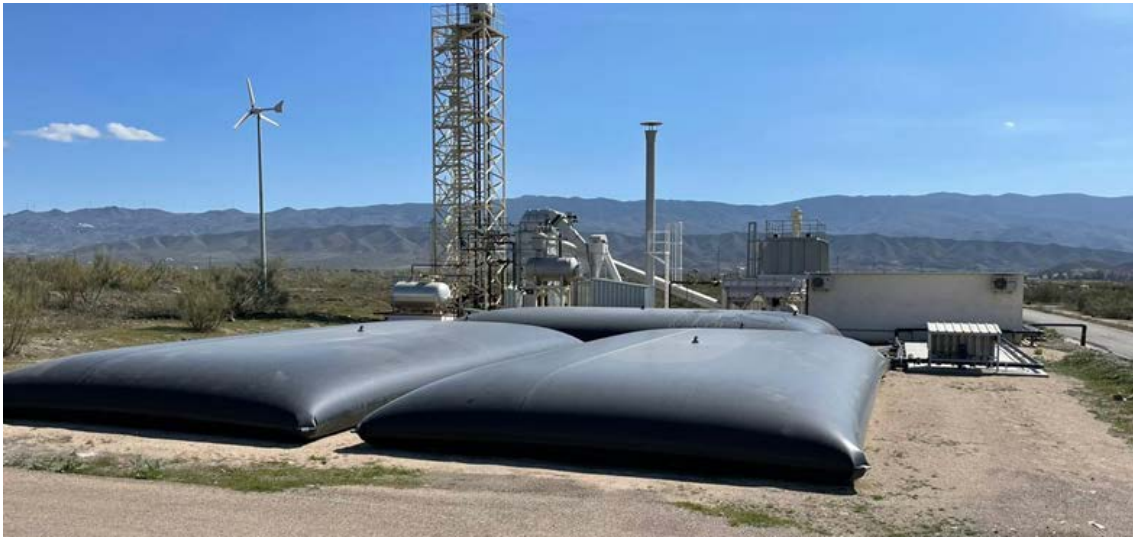
Figura 42. Depósitos llenos de agua de mar real para realizar ensayos de desalación en circuito cerrado.
