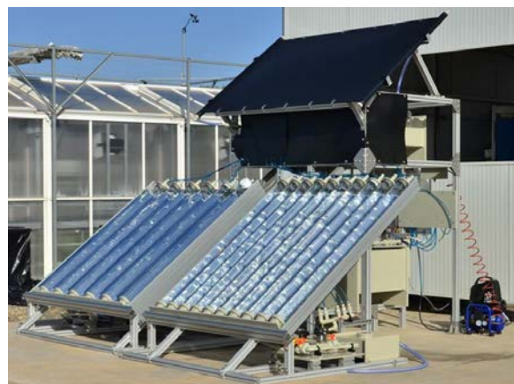
Figura 45. Vista de planta piloto con módulo tipo CPC y tipo-U (NOVA 75 V 1.0).
