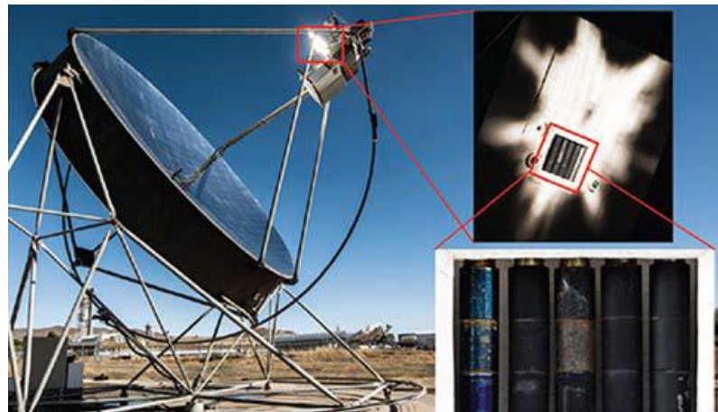
Figura 35. Pruebas de envejecimiento acelerado en prototipos de tubos metálicos en un disco parabólico DISTAL-II.
