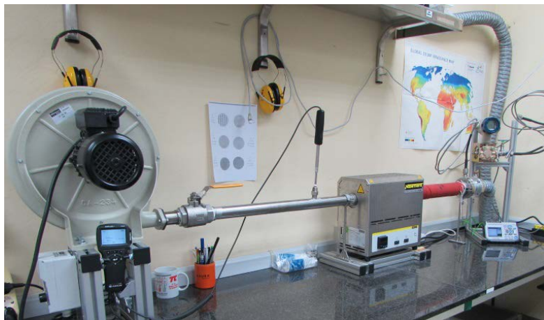
Figura 76. Banco de ensayos para medir diferencias de presiones configurado hasta 300°C.
