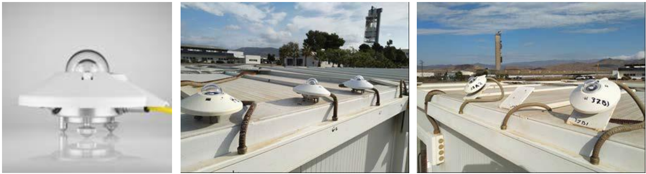
Figura 52. Piranómetro CUV-5 (a). Vista de todos los piranómetros (configuración horizontal (b) e inclinado (c))
