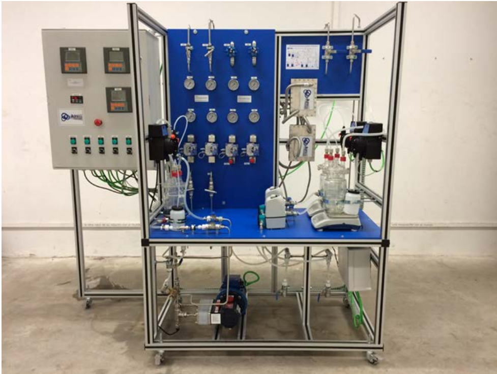
Figura 73. Banco de ensayos para FO y PRO.
