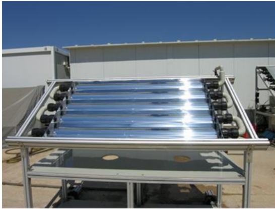
Colector Parabólico Compuesto (CPC)
