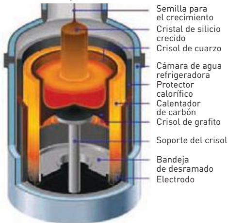
Figura 4.9.7. Cristalización por método Czochralsky
