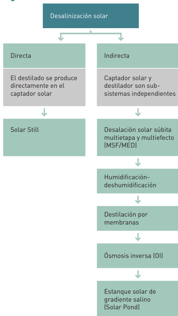
Figura 4.10.15. Desalinización solar térmica
