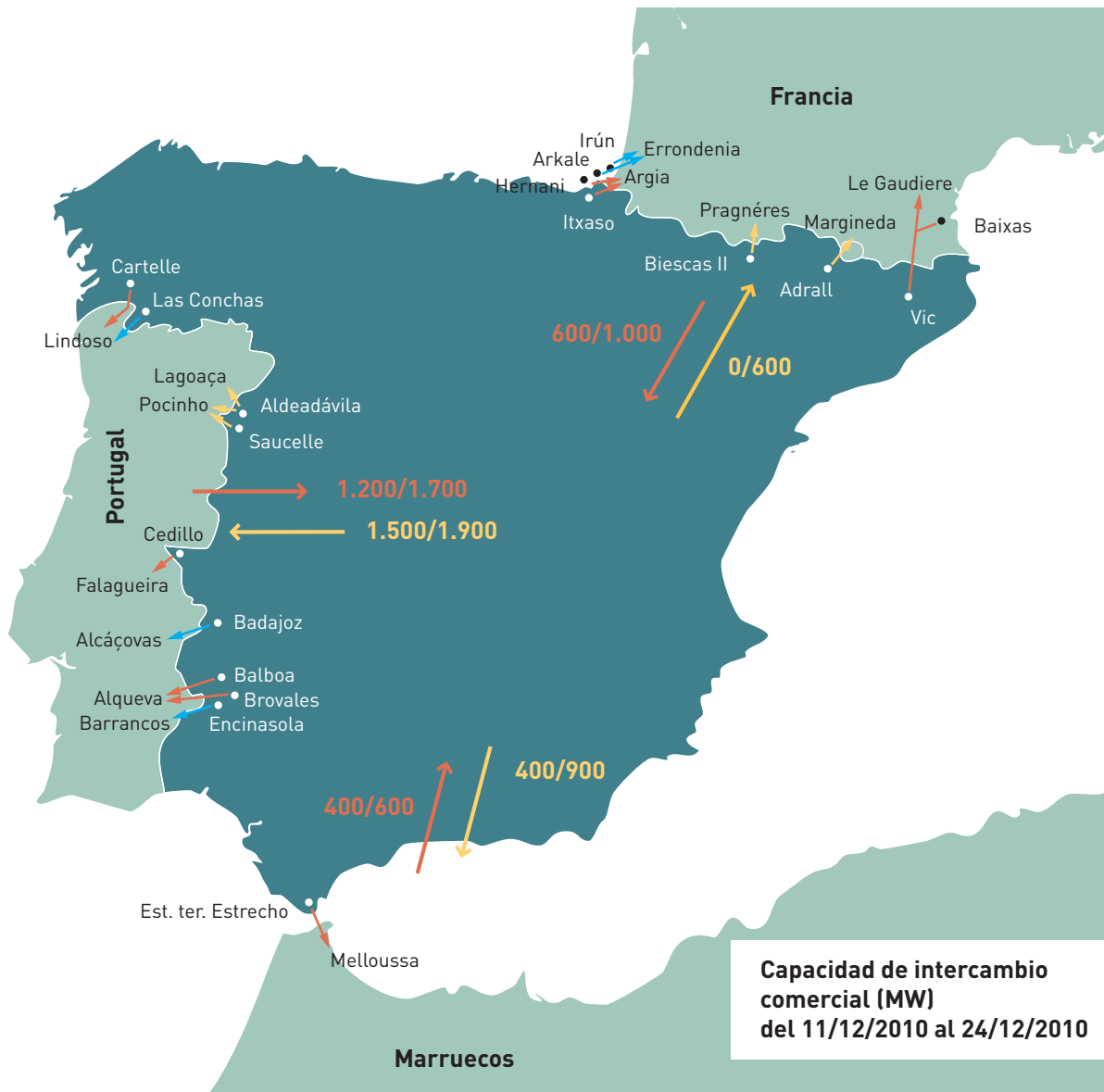
Figura 12.3.1. Capacidad de intercambio comercial de España en MW
