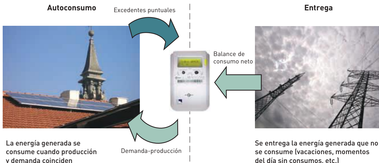
Figura 8.2.1. Ejemplo de sistema de balance neto
