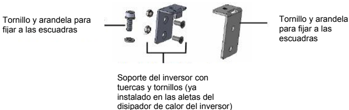
Figura 3. Montaje de soportes y tornillos
